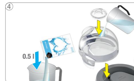
Mezcle 0,5 litros de agua potable fresca con un sobre de descalcificador en un recipiente de medición. Vierta la solución de descalcificación en el depósito de agua e inserte el depósito de agua en la máquina.
