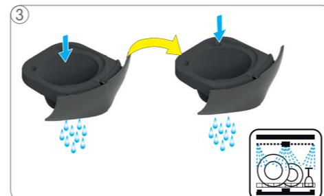
Limpie con líquido detergente y agua potable fresca ambos lados del soporte de la cápsula. Como alternativa puede lavarse en el lavavajillas. Séquelo a continuación.
