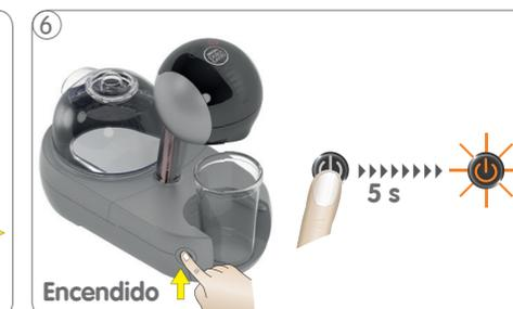
Pulse y mantenga pulsado el botón de encendido durante al menos 5 segundos. El botón de encendido comienza a parpadear en verde y la máquina entra en el modo de descalcificación.
