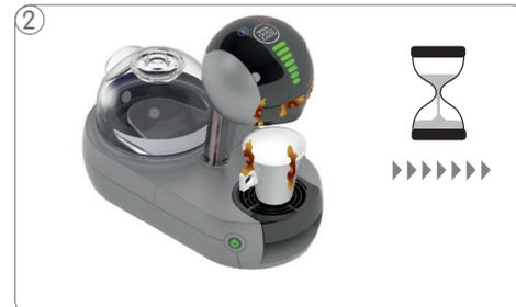
La mezcla de café se presiona en la parte superior del soporte de la cápsula. Espere hasta que el proceso de prensado haya finalizado. Este será el caso cuando no escuche ningún ruido proveniente de la máquina.
