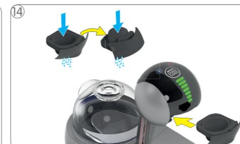
Enjuague el soporte de la cápsula con agua potable fresca por ambos lados. Seque el soporte de la cápsula. Insértelo en la máquina. Disfrute de su bebida.
