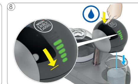
Pulse el icono de agua fría. El display de barras comienza la cuenta atrás. La máquina se descalcifica en funcionamiento de inicio-parada durante aproximadamente 2 minutos hasta que el depósito de agua se vacía.
