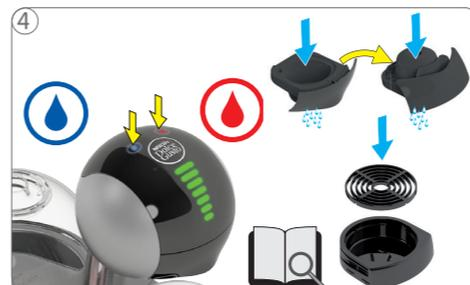
Enjuague la máquina, para ello siga las instrucciones de "5. PRIMERA PUESTA EN FUNCIONAMIENTO" en la página 8. Limpie con líquido detergente y agua potable fresca ambos lados del soporte de la cápsula. Enjuague la bandeja de escurrido con agua potable fresca y límpiela con un cepillo limpio adecuado para alimentos.
