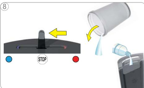
8 Después de aprox. 60 segundos, poner la palanca de selección en la posición "ALTO". Vaciar la jarra y llenar nuevamente el depósito de agua con agua potable fresca.
