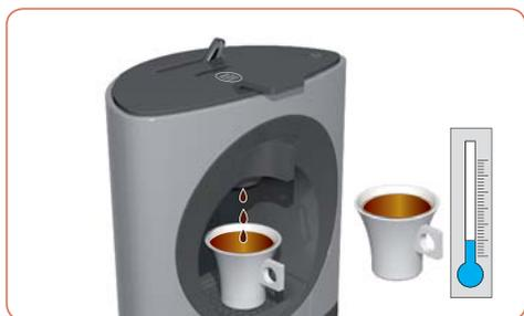
**Si la bebida sale más lento de lo normal (aún en goteo), si la bebida queda más fría de lo normal o si el botón de encendido se ilumina de forma permanente en color naranja, es necesario descalcificar la máquina.**
