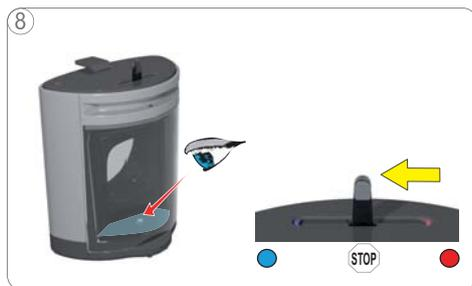
Cuando el depósito de agua quede vacío, colocar la palanca de selección en la posición "ALTO".
