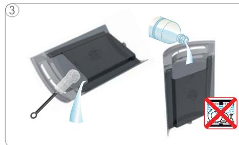
3 Enjuagar y limpiar el depósito de agua. Después, rellenarlo con agua potable fresca e insertarlo en la máquina. El depósito de agua no es apto para lavavajillas.
