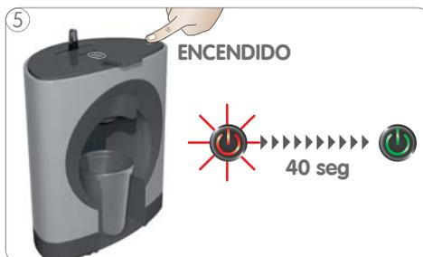
5 Encender la máquina. El botón de encendido comienza a parpadear en rojo mientras la máquina se calienta durante aprox. 40 segundos. Después el botón de encendido se ilumina permanentemente en verde y la máquina está lista para funcionar.
