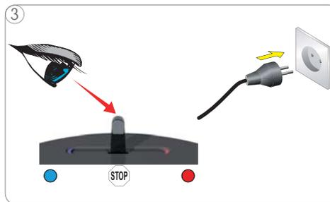
3 Comprobar que la palanca de selección esté en la posición "ALTO". Luego enchufar el enchufe de alimentación en una toma de corriente.
