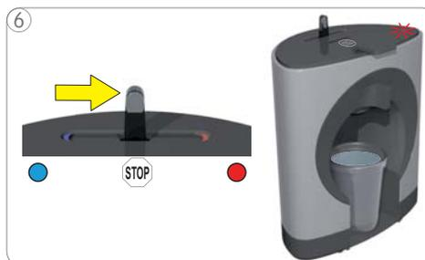
6 Después de aprox. 60 segundos, poner la palanca de selección en la posición "ALTO". La máquina para el enjuague y el botón de encendido parpadea en rojo durante unos 5 segundos.
