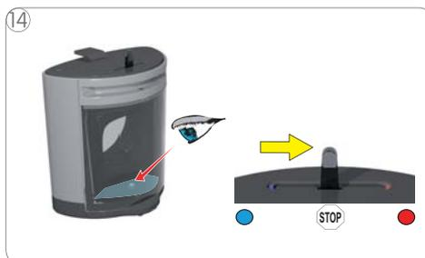
14 Revisar visualmente cuando el depósito de agua quede vacío. Colocar la palanca de selección en la posición "ALTO".
