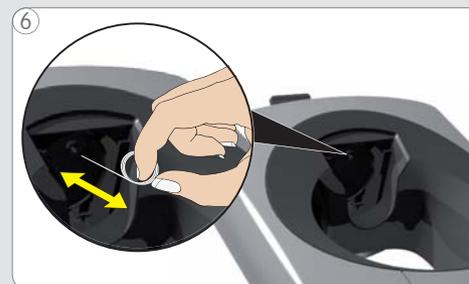
Desbloquear el inyector con la agua de limpieza. Se recomienda efectuar una descalcificación de la máquina.
