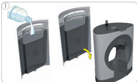
1 Enjuagar primero el depósito de agua. Llenar el depósito de agua con agua potable fresca. Introducir el depósito de agua en la máquina.
