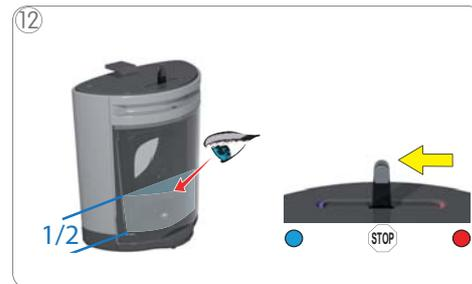
12 Revisar visualmente cuando el depósito de agua se encuentre a la mitad. Colocar la palanca de selección en la posición "ALTO".
