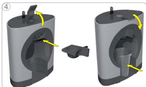
4 Abrir la manija de bloqueo e insertar el soporte de la cápsula vacío. Cierre la palanca de bloqueo. Llene el depósito de agua de la máquina con agua limpia hasta el nivel máximo y colóquelo.
