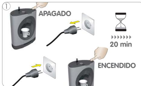
1. Apagar la máquina. Comprobar si la cápsula está bloqueada (véase la página 12). Desenchufar el enchufe de alimentación y esperar 20 minutos. Transcurrido este tiempo, enchufar el enchufe en la toma de corriente y encender la máquina.
