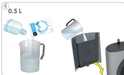
Mezcle 0,5 litros de agua con el contenido de un sobre de polvo descalcificador en el depósito de la máquina. Verter la solución de descalcificación en el depósito de agua e insertar el depósito de agua en la máquina.
