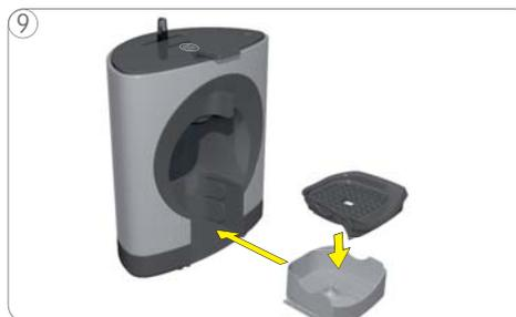
9 Colocar la rejilla de escurrido sobre la bandeja de escurrido. Luego insertar la bandeja de escurrido en la posición deseada de la máquina.
