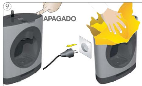
9 Apagar la máquina. Desenchufar la máquina. Limpiar la máquina con un paño suave y húmedo. Después, secarla con otro paño seco.
