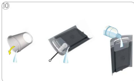
10 Vaciar el contenedor y el depósito del agua. Limpiar el depósito con un cepillo. Después, rellenarlo con agua potable fresca e insertarlo en la máquina.
