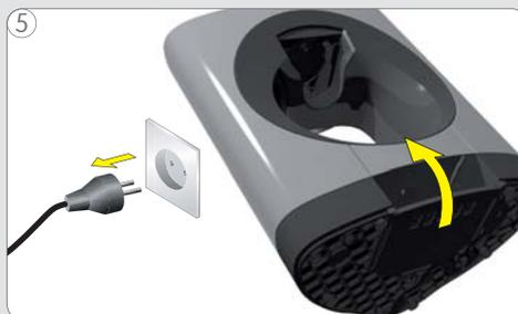
Desenchufar la máquina. Inclinarse la máquina para acceder mejor al inyector.
