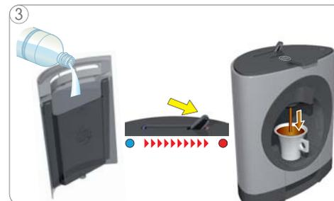
3 Comprobar si hay agua en el depósito de agua: si no es así, rellenar y mover la palanca de nuevo a la posición frío/caliente para continuar la preparación; en caso positivo, proceder del siguiente modo:
