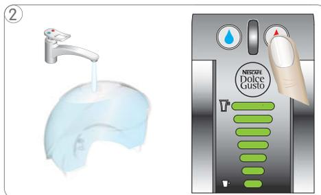
Comprobar si hay agua en el depósito de agua: si no es así, rellenar y pulsar el botón caliente/frío de nuevo para continuar la preparación; si el depósito de agua está lleno proceder del siguiente modo:
