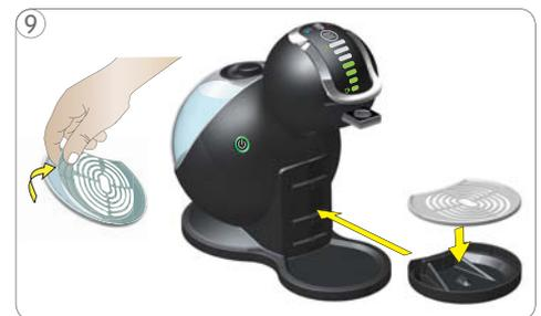
9 Retirar la lámina protectora de la rejilla apoya-tazas. Colocar la rejilla apoya-tazas sobre la bandeja recoge gotas. A continuación acoplar la bandeja recoge gotas en la posición desecada de la máquina.
