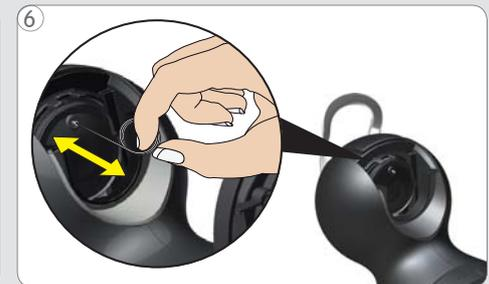
Desbloquear el inyector con el agua de limpieza.
