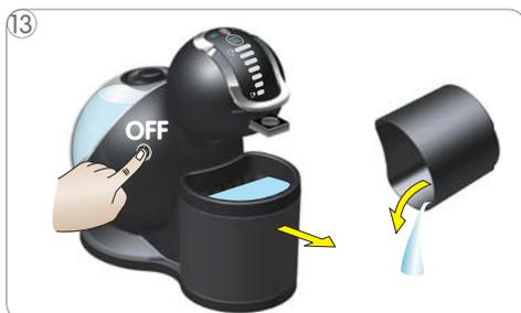
Esperar hasta que la máquina cambie de vuelta a funcionamiento normal. Luego apagar la máquina. Retirar y vaciar el depósito de cápsulas.
