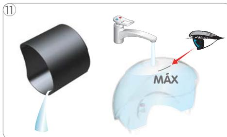
Vaciar el depósito de cápsulas. Llenar el depósito de agua con agua potable fresca hasta el nivel máx.
