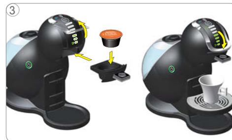
3 Subir la palanca y tirar hacia fuera el soporte de la cápsula. Insertar la cápsula en el soporte de la cápsula e insertarlo de nuevo en la máquina. Bajar palanca.
