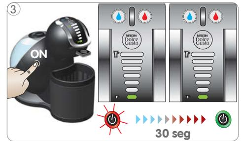
3 Encender la máquina. Mientras la máquina se está calentando, el botón de encendido comienza a parpadear en rojo. 30 segundos, el botón de encendido se ilumina permanentemente en verde y la máquina ya está preparada.
