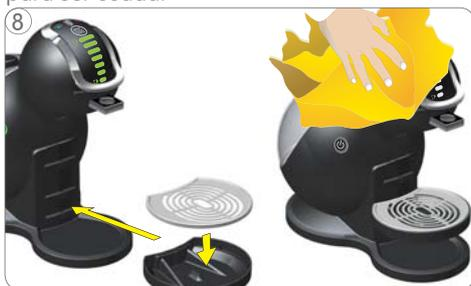
8 Colocar la rejilla apoya-tazas sobre la bandeja recoge gotas. Luego acoplar la bandeja recoge gotas en la posición deseada de la máquina. Limpiar la máquina con un paño húmedo y suave. Secarla después con un paño seco y suave.
