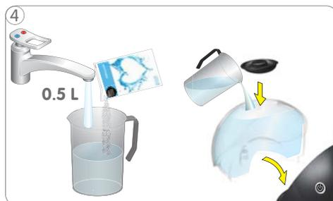
Mezclar 0.5 litro de agua potable con un sobre de descalcificación en un recipiente de medición. Verter la solución de descalcificación en el depósito de agua.
