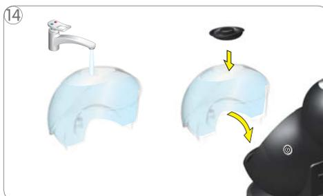
Rellenar el depósito de agua con agua potable y colocarlo de nuevo en la máquina.
