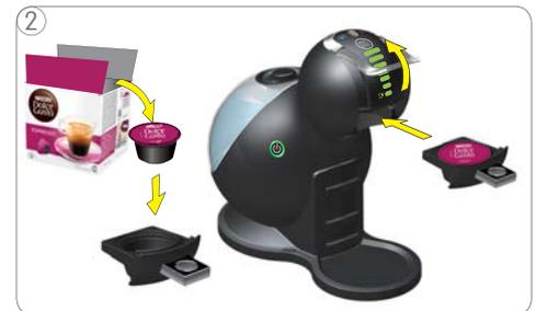
2 Insertar una nueva cápsula en el soporte de la cápsula e insertarlo de nuevo en la máquina.
