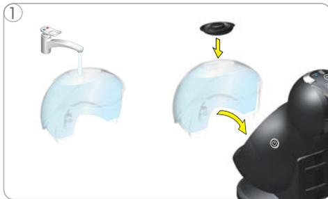
1 Enjuagar primero el depósito de agua. Llenar el depósito con agua potable. Colocar la tapa e insertar el depósito de agua en la máquina.
