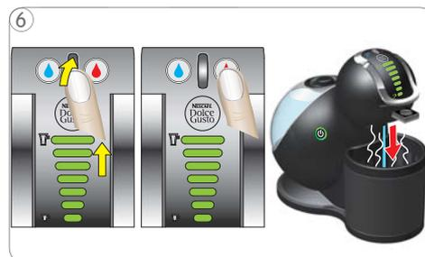
6 Enjuagar la máquina del siguiente modo: Encender todas las barras hasta el nivel máx. utilizando la rueda de selección y pulsar el botón de caliente. La máquina comienza el enjuague. Las luces del display de barras se apagan progresivamente.
