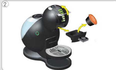
Levantar la palanca y retirar el soporte de la cápsula.
