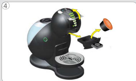
Luego levantar la palanca de bloqueo y retirar el soporte de la cápsula.
