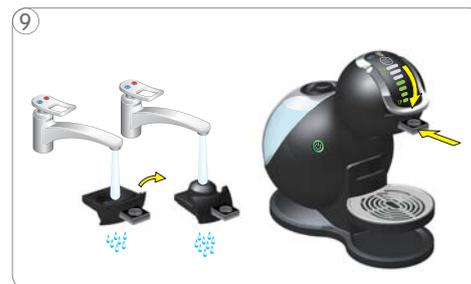
9 Enjuagar con agua y secar el soporte de la cápsula por ambos lados. Insertar el soporte de la cápsula en la máquina. ¡Disfrute de su bebida!
