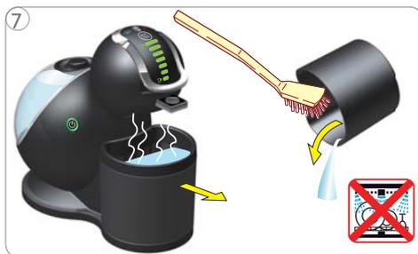
7 Esperar hasta que finalice la cuenta atrás y se pare la dispensación de agua. Vaciar y limpiar el depósito de cápsulas.
