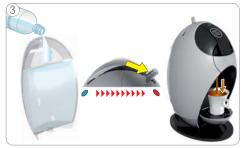
Comprobar si hay agua en el depósito de aqua: si no es así, rellenar y mover la palanca de nuevo a la posición frío/caliente para continuar la preparación; en caso positivo, proceder del siguiente modo:
