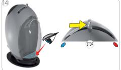
Revisar visualmente cuando el depósito de agua quede vacío. Colocar la palanca de selección en la posición "STOP".
