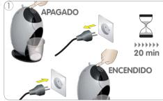
Apagar la máquina. Comprobar si la cápsula está bloqueada (véase la página 12). Desenchufar el enchufe de alimentación y esperar 20 minutos. Transcurrido este tiempo, enchufar números de la línea de atención, véase el el enchufe en la toma de corriente y encender la máquina.
