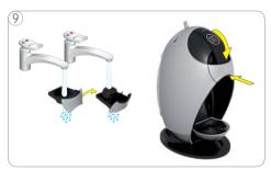
Enjuagar con agua y secar el soporte de la cápsula por ambos lados. Insertar el soporte de la cápsula en la máquina. ¡Disfrute de su bebida!
