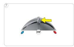
Después de aprox. 10 segundos, poner la palanca de selección en la posición "ALTO". Vaciar y limpiar la jarra con herramientas de limpieza limpias.
