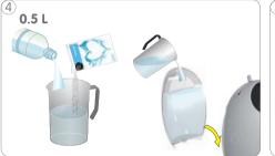
Mezcle 0,5 litros de agua con el contenido de un sobre de polvo descalcificador en el depósito de la máquina. Verter la solución de descalcificación en el depósito de agua e insertar el depósito de agua en la máquina.
