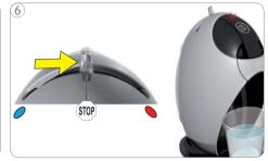
Después de aprox. 60 segundos, poner la palanca de selección en la posición "STOP". La máquina para el enjuague y el botón de encendido parpadea en rojo durante unos 5 segundos.
