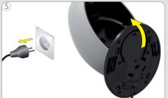
Desenchufar la máquina. Inclinar la máquina para acceder mejor al inyector.
