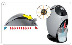
Poner la palanca de selección en la posición "CALIENTE". La máquina comienza a enjuagar, el botón de encendido parpadea en color naranja. Dejar que toda la solución de descalcificación pase a través del sistema de aqua.
