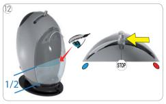
Revisar visualmente cuando el depósito de agua se encuentre a la mitad. Colocar la palanca de selección en la posición "STOP".
