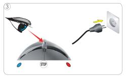
Comprobar que la palanca de selección está en la posición "STOP". Luego enchufar el enchufe de alimentación en una toma de corriente.
