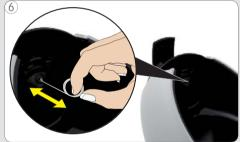
Desbloquear el inyector con la aguja de limpieza. Se recomienda efectuar una descalcificación de la máquina.
