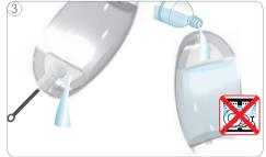
Enjuagar y limpiar el depósito de agua con herramientas de limpieza limpias. Después, rellenarlo con aqua potable fresca e insertarlo en la máquina. El depósito de aqua no es apto para lavavajillas.
