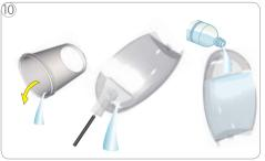
Vaciar la jarra y el depósito de agua. Enjuagar y limpiar el depósito de agua con herramientas de limpieza limpias. Después, rellenarlo con agua potable fresca e insertarlo en la máquina.
