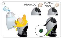
Rellenar el depósito de agua con agua potable fresca e insertarlo en la máquina. Limpiar la máquina con un paño húmedo y suave. Secarla después con un paño seco y suave. Apagar la máquina. Encender la máquina. El botón de encendido comienza a parpadear en color verde.
