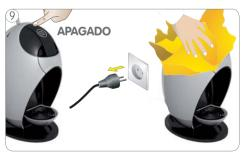
Colocar la rejilla de escurrido sobre la bandeja Apagar la máquina. Desenchufar la máquina. Limpiar la máquina con un paño suave y hú-
