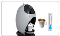
Si la bebida sale más lento de lo normal (incluso en goteo), si la bebida queda más fría de lo normal o si el botón de encendido se ilumina de forma permanente en color naranja, es necesario descalcificar la máquina.
