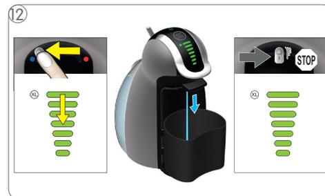
Mueva la palanca a la izquierda para iniciar el enjuague. El display de barras comienza la cuenta atrás. Espere hasta que la palanca vuelva al centro y termine la extracción de agua.
