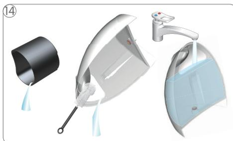
Vaciar y limpiar el depósito de cápsulas. Enjuagar y limpiar el depósito de agua. Después, rellenarlo con agua potable fresca e insertarlo en la máquina.
