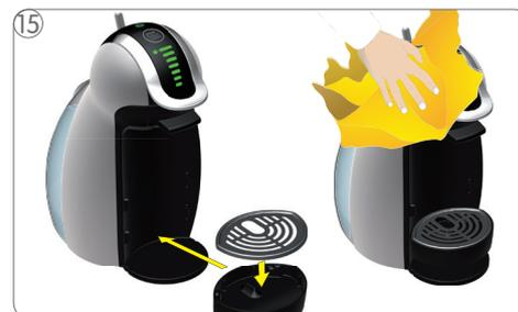
Colocar la rejilla recoge gotas sobre la bandeja recoge gotas. Luego insertar la bandeja recoge gotas en la posición deseada de la máquina. Limpiar la máquina con un paño húmedo y suave. Secarla después con un paño seco y suave.
