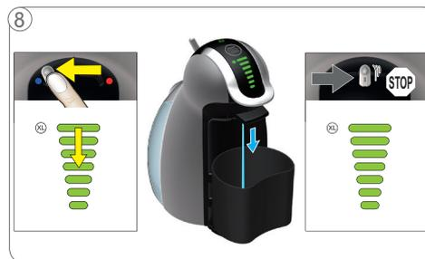
8 Mover la palanca a la izquierda. El display de barras comienza la cuenta atrás. La máquina estará en proceso de descalcificación durante aproximadamente 2 minutos. La palanca volverá a la posición central.
