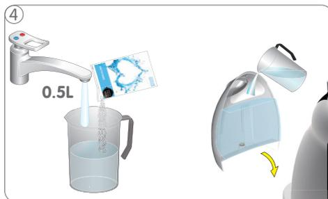
4 Mezcle 0.5 litro de agua con el contenido de un sobre de polvo descalcificador en el depósito de la máquina. Verter la solución de descalcificación en el depósito de agua e insertar el depósito de agua en la máquina.
